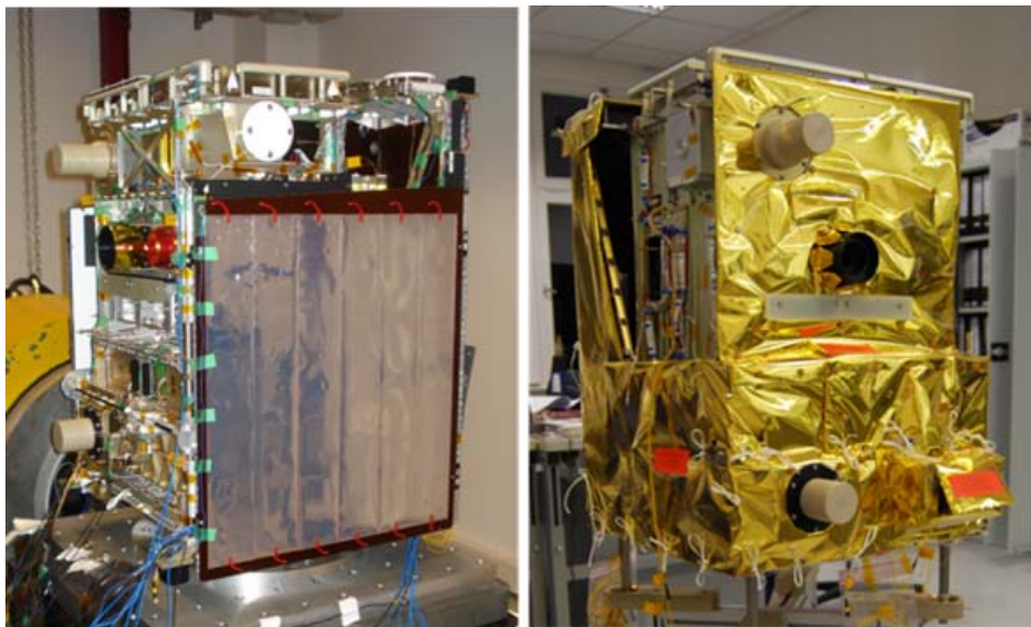
Fig. 13. Structure / Thermal model of the mini satellite TET-1
